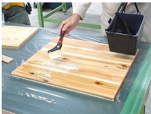
写真 10 超撥水層の塗工の様子
