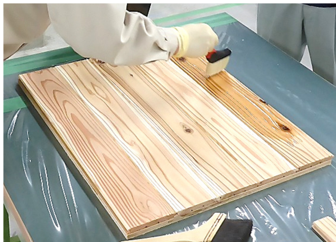
写真9 下地層の塗工の様子
